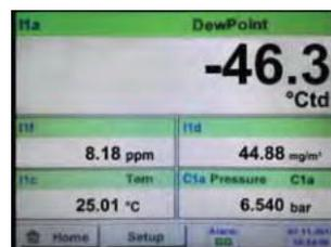
Alle physikalischen Messgrößen der Feuchtemessung werden automatisch berechnet. Beim IPI 500 werden zusätzlich die Messwerte des externen Fühlers angezeigt.
