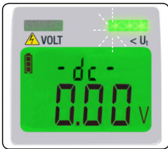
Displaybeleuchtung grün, nach 5 s aus
