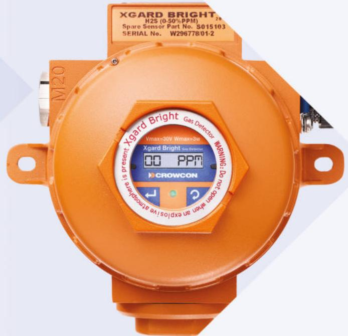
Die 4-adrige Busleitung senkt die Installationskosten und reduziert den Verkabelungsaufwand drastisch. Mit dem großen OLED-Display können Benutzer während der Installation, Kalibrierung und Routinewartung problemlos mit Xgard Bright arbeiten, ohne das Gehäuse öffnen zu müssen.
