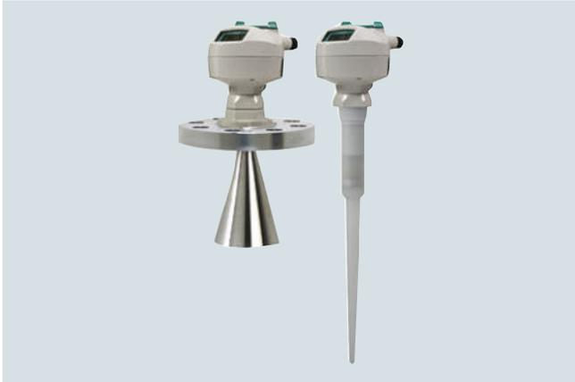
SITRANS LR200 ist ein 6 GHz Pulsradar-Füllstandmessumformer in Zweileiter-Technik für Messbereiche bis 20 m (65 ft). Er eignet sich für die kontinuierliche Überwachung von Flüssigkeiten und Schlämmen in Lager- und Prozessbehältern, auch bei hohen Temperaturen, Druck, Rührwerken und Turbulenzen.
