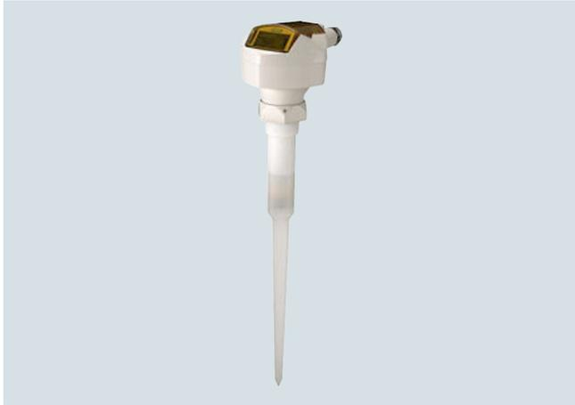
SITRANS Probe LR ist ein 6 GHz Pulsradar-Füllstandmessumformer in Zweileiter-Technik für Messbereiche bis 20 m (66 ft). Er eignet sich für die kontinuierliche Überwachung von Flüssigkeiten und Schlämmen in drucklosen Lagerbehältern mit normalen Umgebungsbedingungen.
