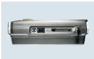
Seitlicher Anschluss von Mini-USB-Kabel und SD-Karte
