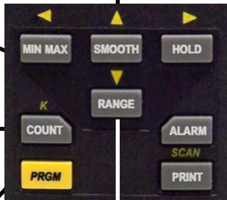
Durch die Taste HOLD wird der letzte Messwert in der Anzeige gehalten. Die analoge Bargraph-Anzeige zeigt weiter den aktuellen Messwert an.
