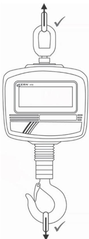
**Nur Lastanschlagmittel verwenden, die Ein-Punkt-Aufnahme gewährleisten und an denen die Waage frei hängen kann.**
