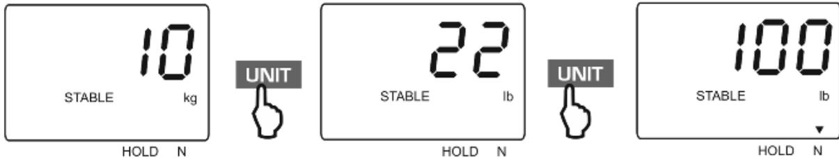
Mit jedem Druck der **UNIT**-Taste wird die nächste Wägeeinheit angezeigt
