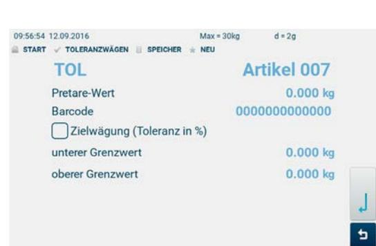
„Toleranzwägen nach Einstellung eines oberen und unteren Grenzwertes!“.
