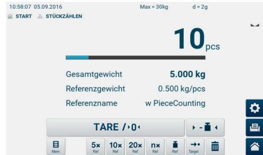
Aufgelegte Referenzstückzahl (z.B.
