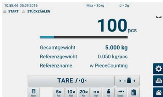
Die Waage ermittelt das Referenzstückgewicht. Referenzgewicht abnehmen. Ab hier befindet sich Waage im Stückzahl-Modus und zählt alle Teile, die sich auf der Wägeplatte befinden.
