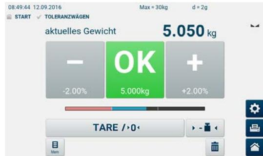
Abhängig vom aufgelegten Gewicht wechselt die Farbe der Indikatoren <->, <OK> oder <+>. Ein Signalton unterstützt das Erreichen des Zielwertes.
