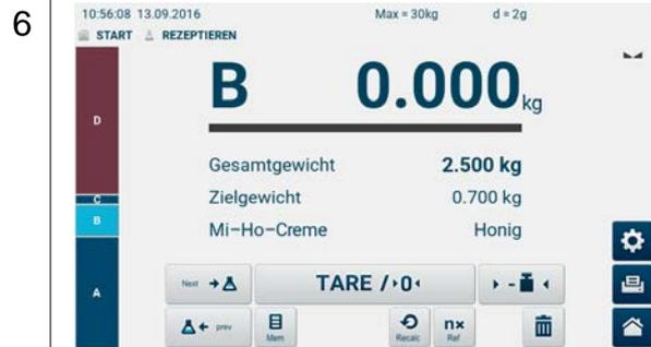
Die Waage ist bereit für das Einwiegen der zweiten Komponente.
