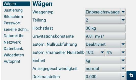
Die Konfigurationsparameter werden angezeigt. Im Pull-Down-Menü die gewünschte Parameter wählen, s. Kap. 9.2.
