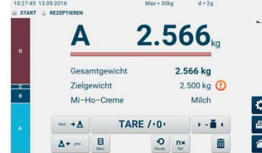
Einwaage der Komponente liegt unter dem Sollgewicht / Toleranz
