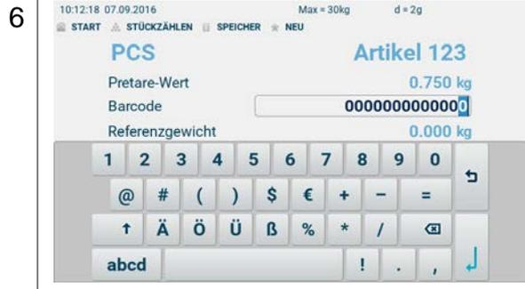
Barcode händisch eingeben und mit
