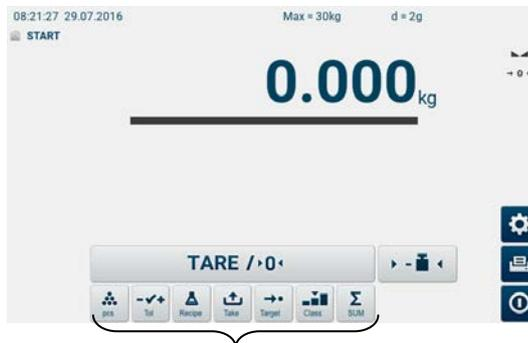
Die Anzahl der verfügbaren Applikationen kann jedoch unter <Bediener Setup ➔ Funktionen> benutzerspezifisch angepasst werden.
