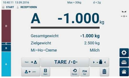
Die Waage ist für das Einwägen der ersten Komponente bereit. Die Bezeichnung und das Sollgewicht werden angezeigt.
