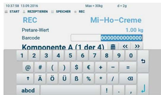
Ggf. Barcode händisch eingeben und mit
