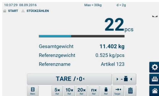
Die zu zählenden Teile auflegen, die Stückzahl wird berechnet und angezeigt.
