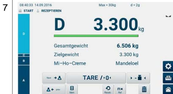
Nach Einwaage der letzten Komponente können bei Anschluss eines optionalen Druckers die Einzelgewichte der Komponenten und das aufsummierte Gesamtgewicht ausgedruckt werden (je nach Einstellung im Menü automatisch oder nach Drücken von
