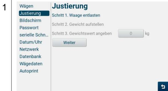
1 Waage entlasten. Darauf achten, dass sich keine Gegenstände auf der Wägeplatte befinden. <Weiter> antippen.
