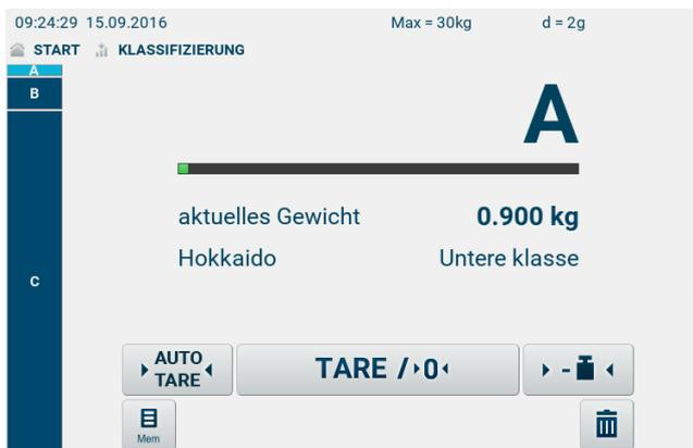
Artikel auflegen. Die Klasse entsprechend dem aufgelegten Gewicht wird angezeigt. Bei Anschluss eines optionalen Druckers erfolgt die Ausgabe eines Messprotokolls (je nach Einstellung im Menü automatisch oder nach Drücken von
