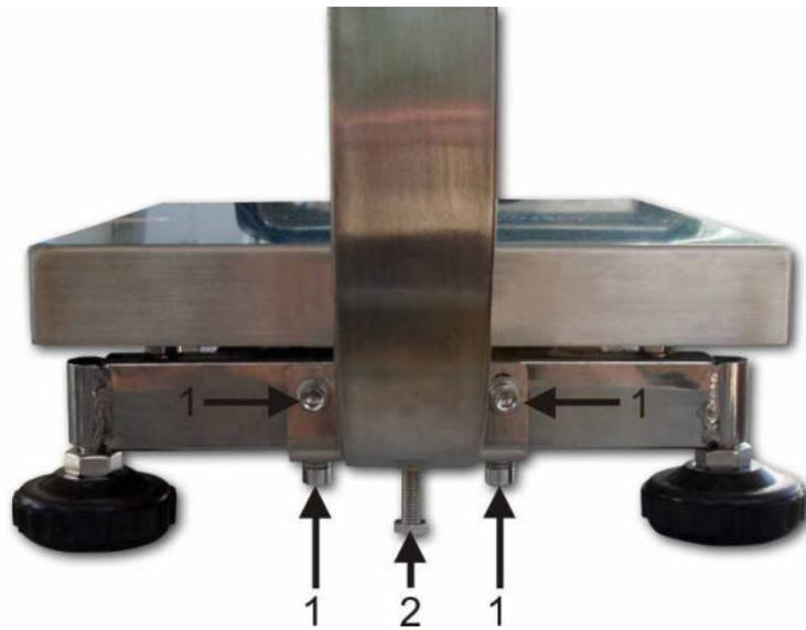
Stativ lt. Abb. mit den 4 Schrauben [1], Sicherungs- und Unterlegscheiben an der Plattform befestigen. Darauf achten, dass das Kabel nicht eingeklemmt oder beschädigt wird. Stützschraube [2] bis zum sicheren Stand eindrehen.
