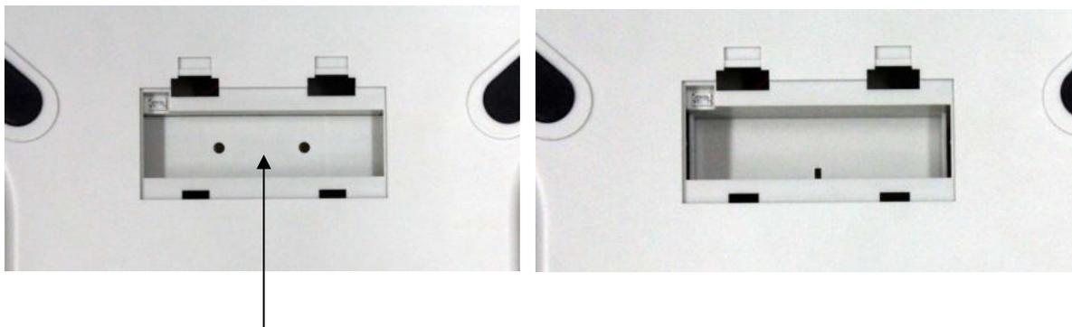
2. Zwischenboden durch verschieben und heraushebeln entfernen
