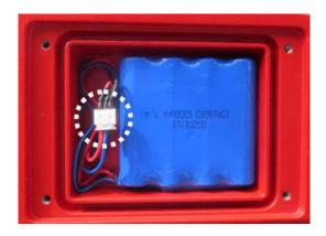
Der Akku sollte vor der ersten Benutzung mindestens 24 Stunden über das Netzkabel geladen werden. Die Betriebsdauer des Akkus beträgt ca. 60 Stunden. Ist die Kapazität des Akkus bald erschöpft beginnt die Anzeige zu flackern. Erscheint "Io\_bat", ist die Waage ist noch ca. 30 Minuten betriebsbereit, danach schaltet sie sich automatisch ab. Stecken Sie baldmöglichst das Netzkabel ein, um den Akku zu laden.
