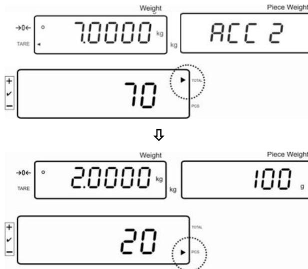
⇒ Nach Bedarf weiteres Wägegut wie vorhergehend beschrieben summieren. Darauf achten, dass das Wägesystem zwischen den einzelnen Wägungen entlastet werden muss.
