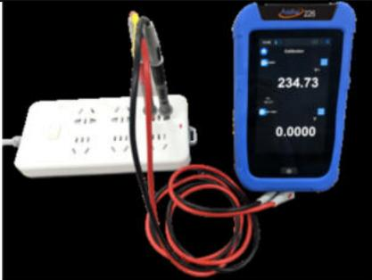
Die Non-Ex-Version des Additel 226 ist mit einer "True Effective Value"-RMS-Messfunktion ausgestattet, die den Effektivwert verschiedener Spannungsformen messen kann. Verzerrungen oder Kurvenparameter und unterschiedliche Fehler, die durch verschiedene Quellen verursacht werden, müssen daher nicht berücksichtigt werden.
