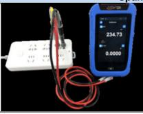
Die Non-Ex-Version des Additel 227 ist mit einer "True Effective Value"-RMS-Messfunktion ausgestattet, die den Effektivwert verschiedener Spannungsformen messen kann. Verzerrungen oder Kurvenparameter und unterschiedliche Fehler, die durch verschiedene Quellen verursacht werden, müssen daher nicht berücksichtigt werden.
