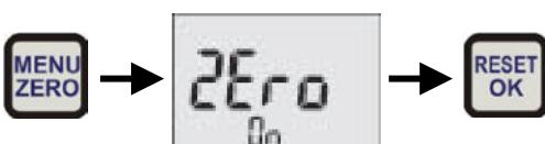
Die Nullpunktkorrektur ist durchgeführt. Im Display erscheint 0.0 bar als IST-Wert. Der Abgleich bleibt aktiviert, bis das Gerät ausgeschaltet wird.
