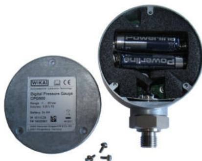
Öffnen Sie das Batteriefach. Setzen Sie die neuen Batterien gemäß Abbildung ein. Achten Sie auf die Polarität der Batterie.
