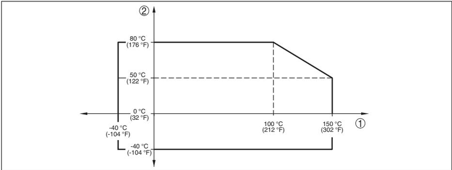
Abb. 36: Temperaturderating CPT-2x, Ausführung bis +150 °C (+302 °F)
