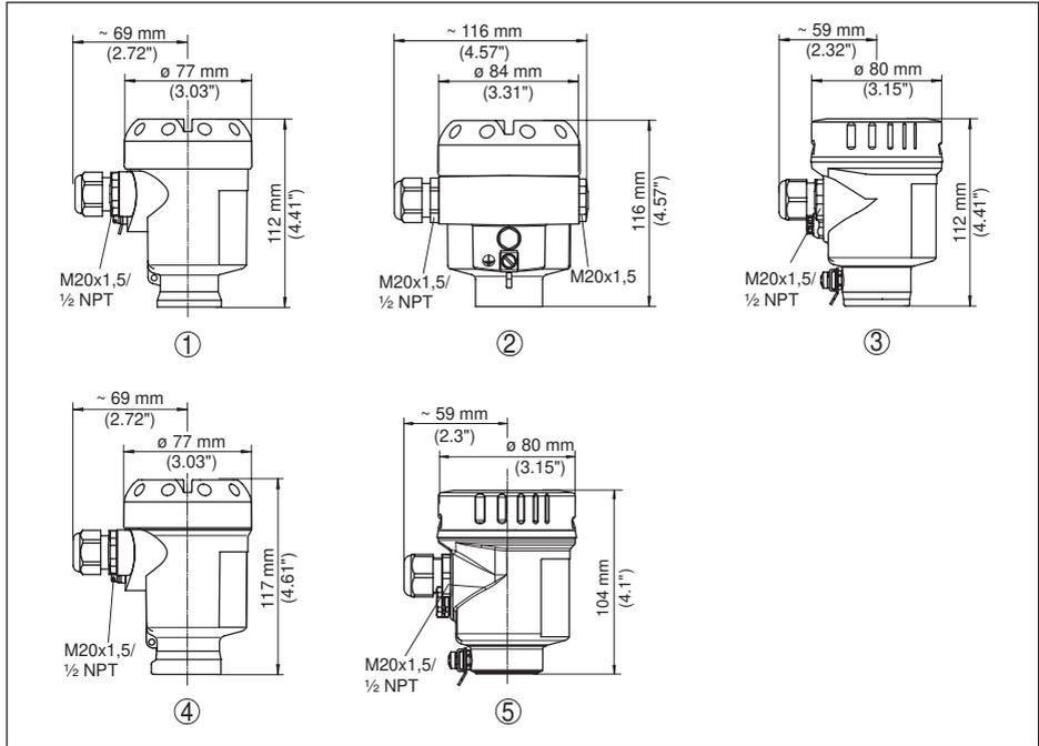
Abb. 38: Gehäuseausführungen in Schutzart IP66/IP67 und IP66/IP68 (0,2 bar)
