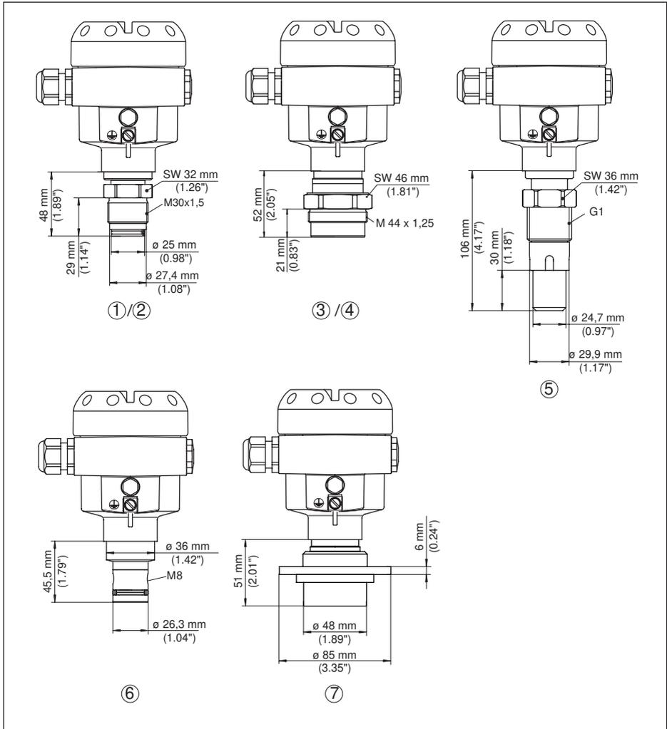
Abb. 44: CPT-2x, Tubusanschluss
