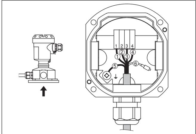
Abb. 25: Anschluss des Sensors im Gehäusesockel
