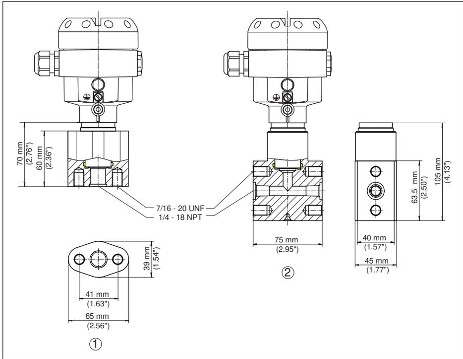
Abb. 45: CPT-2x, Anschluss nach IEC 61518
