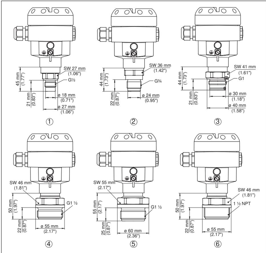
Abb. 41: CPT-2x, Gewindeanschluss frontbündig
