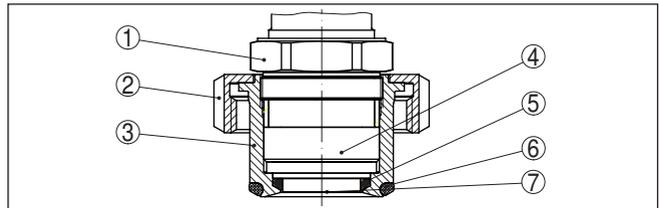
Abb. 30: CPT-2x, Aufbau aseptischer Anschluss mit Nutüberwurfmutter
