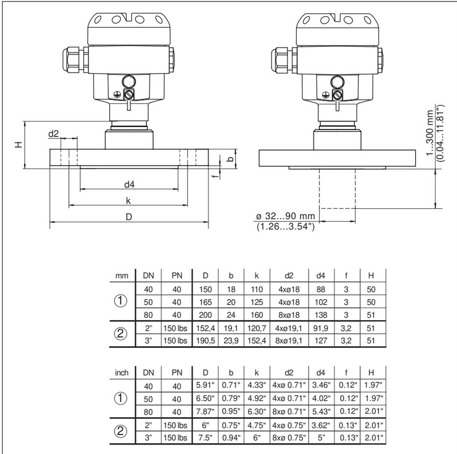
Abb. 43: CPT-2x, Flanschanschluss
