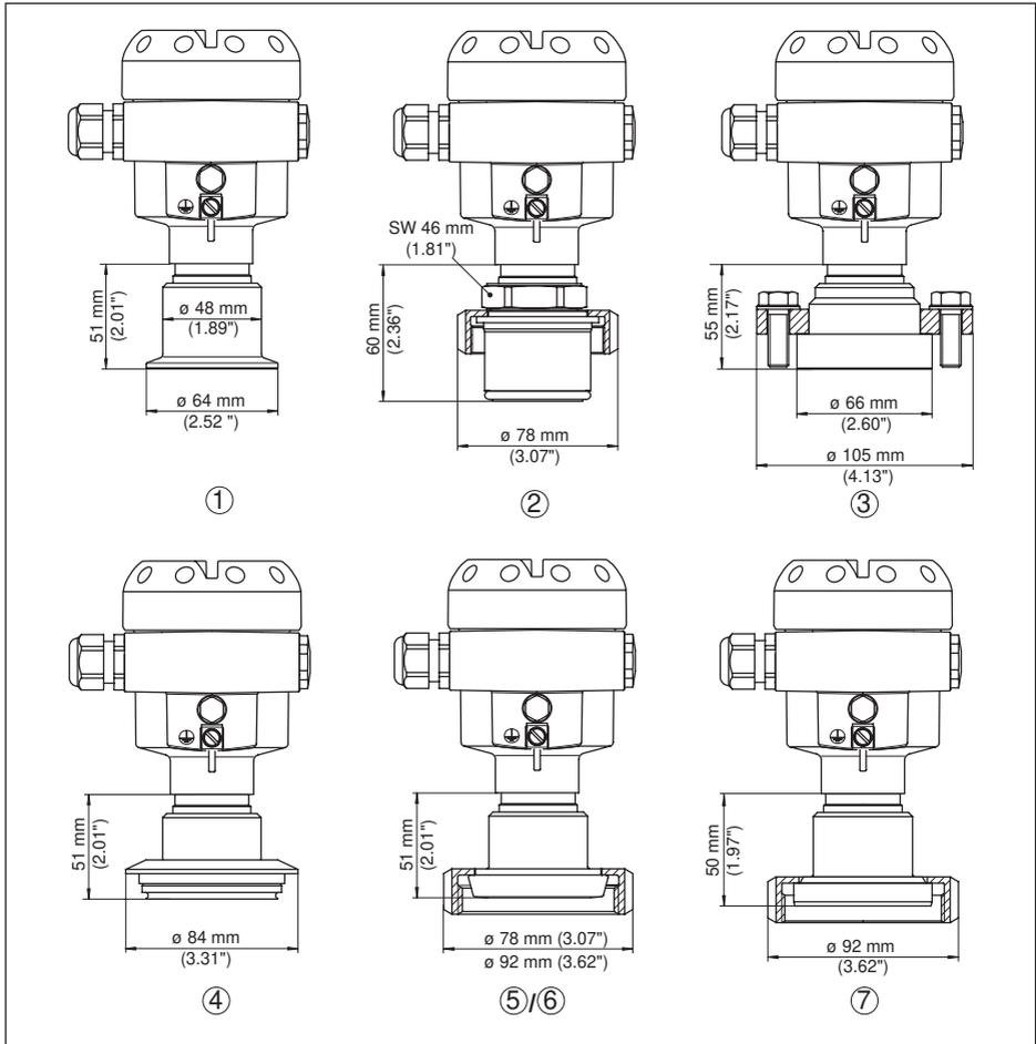
Abb. 42: CPT-2x, Hygieneanschluss
