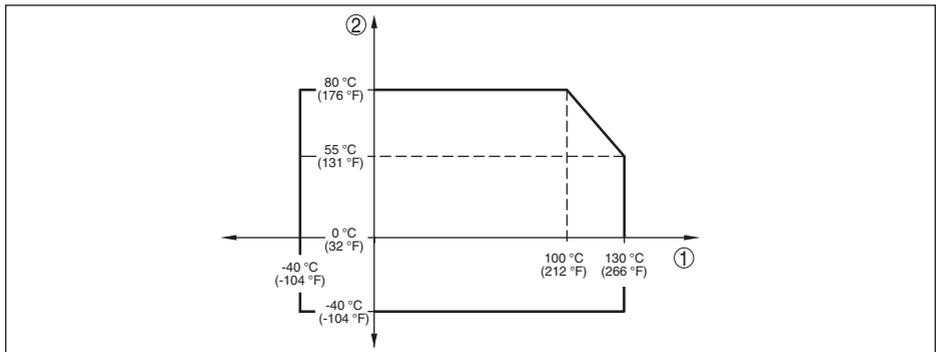
Abb. 35: Temperaturderating CPT-2x, Ausführung bis +130 °C (+266 °F)
