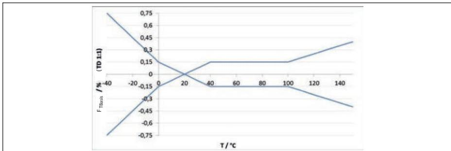
Abb. 33: Basis-Temperaturfehler  $F_{\text{Basis}}$  bei TD 1 : 1
