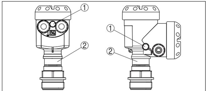
Abb. 14: Position des Filterelementes - gasdichte Durchführung
