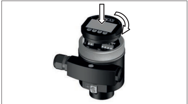
Abb. 29: Einsetzen des Anzeige- und Bedienmoduls beim Einkammergehäuse im Elektronikraum
