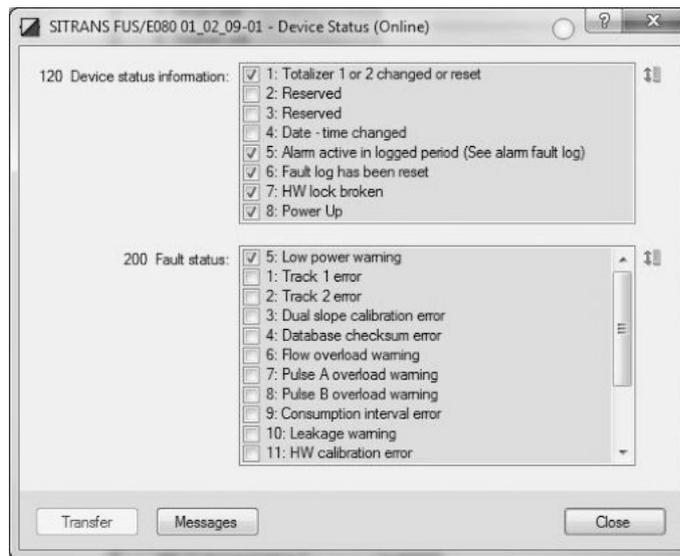
Bild 9-1 Liste der in PDM angezeigten Fehlercodes
