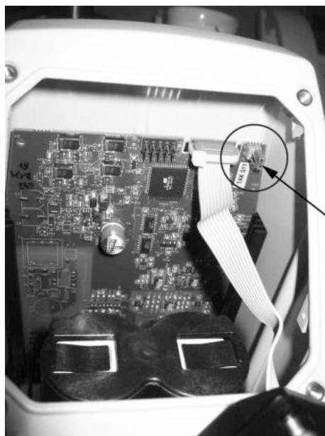
Bild 7-3 Hardwareschlüssel hinter dem Display (auf Stifte rechts gestellt)
