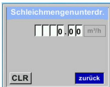
Die Schleichmengenunterdrückung kommt in Anwendung um Verbrauchswerte unterhalb des definierten „LowFlow Cut off“ Wertes als  $0 \text{ m}^3/\text{h}$  anzuzeigen und auch nicht zum Verbrauchszählerstand zu addieren.
