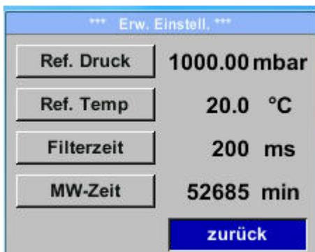
Um Änderungen vorzunehmen, zuerst einen Menüpunkt mit Taste „ $\Delta$ “ anwählen und anschließend mit Taste „OK“ auswählen
