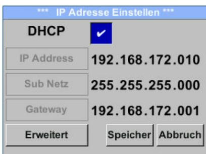
Hier kann eine Verbindung, mit oder ohne *DHCP*, zu einem Rechner eingerichtet und hergestellt werden.
