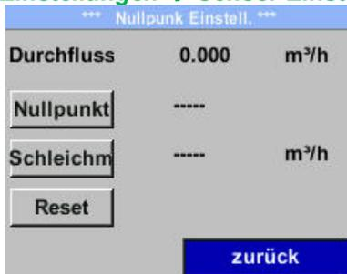
Durch Auswahl **„Reset“** werden Festlegungen für **„Nullpunkt“** bzw. **„Schleimmenge“** zurückgesetzt.
