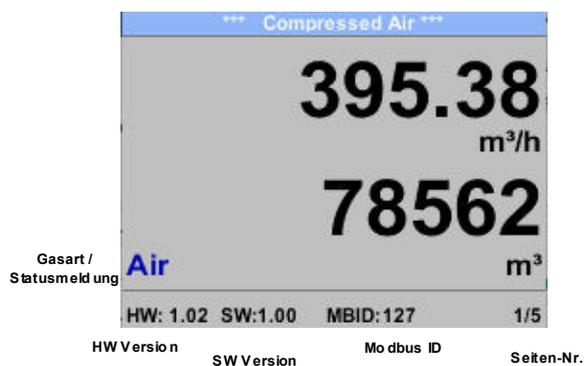
Das Umschalten auf die Seiten 2-5 erfolgt mittels Taste „ $\Delta$ “
