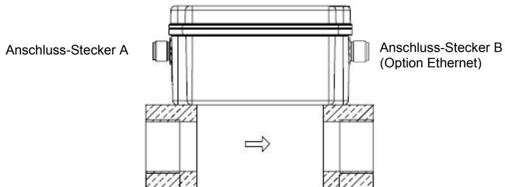
**Achtung:** nicht benötigte Anschlüsse (NC) dürfen nicht auf Potenzial und/ oder Erde gelegt werden. Leitungen abschneiden und isolieren.
