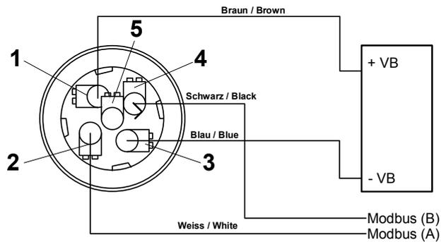
**Achtung:** Wird der Sensor am Ende des Modbussystems eingesetzt ist eine Abschlussterminierung gefordert. Die Sensoren haben eine intern zuschaltbare Terminierung, dazu bitte die 4 Schrauben des Gehäusedeckels lösen und internen DIP Schalter auf „On“ setzen. Beim Zusammenbau auf korrekten Sitz der Gehäusedichtung achten.
