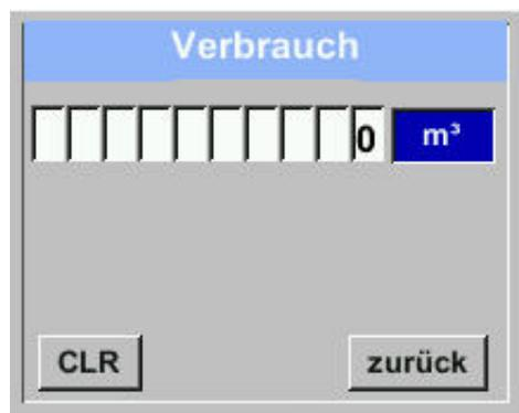
Um Änderungen, z.B. der Einheit, vorzunehmen, muss mittels Taste „ $\Delta$ “ das Tastenfeld „Einheit“ angewählt werden und anschließend mit Taste „OK“ auswählen. Gewünschte Einheit mit Taste „ $\Delta$ “ auswählen und 2x mit Taste „OK“ bestätigen / übernehmen.
