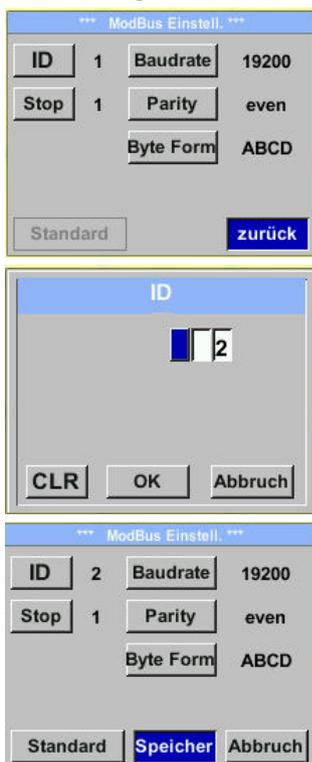
Um Änderungen, z.B. der Sensor ID, vorzunehmen, wird mittels Taste „**△**“ das Feld „**ID**“ selektiert und anschließend mit Taste „**OK**“ ausgewählt.
