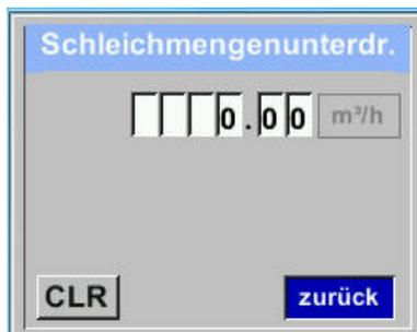
Die Schleimengenunterdrückung kommt in Anwendung um Verbrauchswerte unterhalb des definierten „LowFlow Cut off“ Wertes als 0 m³/h anzuzeigen und auch nicht zum Verbrauchszählerstand zu addieren.
