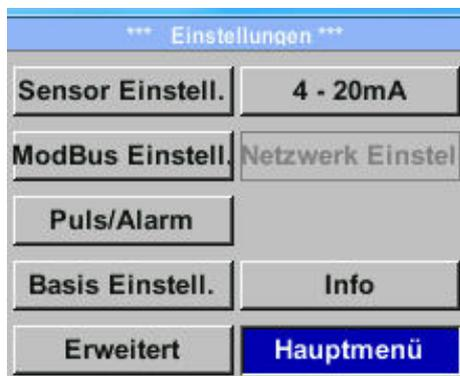
Einen Menüpunkt anzuwählen, Werte zu ändern muss die Taste „△“ bestätigt werden, die Menüpunktauswahl sowie die Werte Bestätigung erfolgt mit der Taste „OK“.
