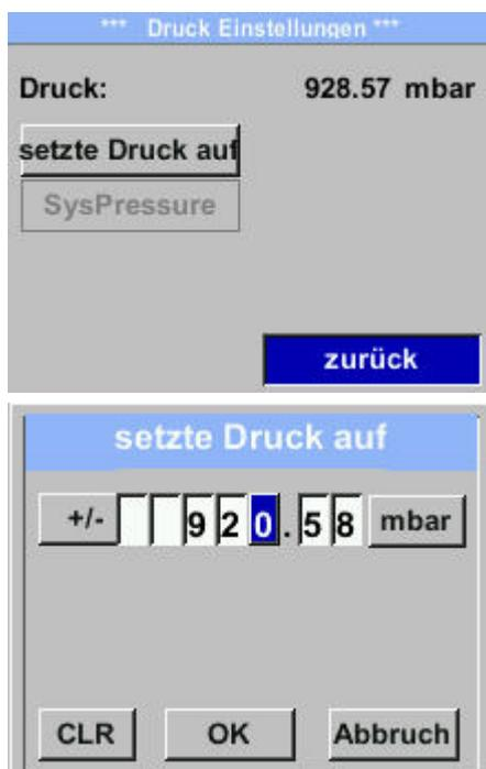
Durch Auswahl „**setze Druck auf**“ kann bei Bedarf eine Druck-Korrektur vorgenommen werden.
