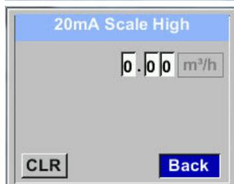
Die Skalierung des 4-20mA kann automatisch mit „Auto Skalierung = ein“ oder manuell „Auto Skalierung = aus“ erfolgen. Mit Taste „ $\Delta$ “ die Anzeige „Auto Skalierung“ anwählen und anschließend mit Taste „OK“ die gewünschte Skalierungsmethode auswählen.
