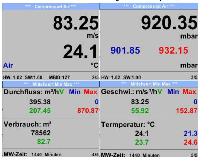
Die MW-Zeit (Zeitraum der Mittelwertbildung) kann über *Sensor Einst. - Erweitert - MW-Zeit* geändert werden.
