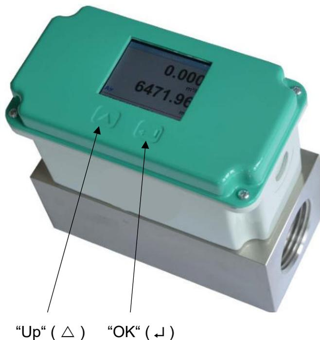
Die Bedienung des IVA 525 erfolgt über die beiden kapazitiven Tasten Up ( $\Delta$ ) und OK ( $\downarrow$ )
