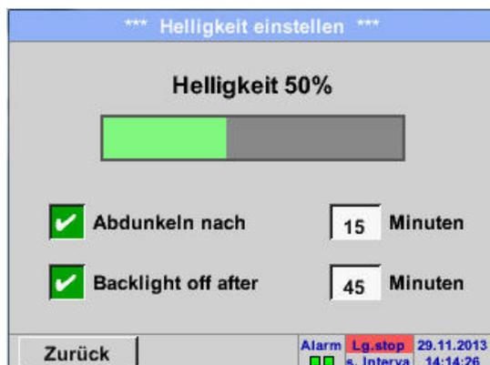
Mit Hilfe des *Abdunkeln-nach*-Knopfes kann, nach Ablauf eines zu definierenden Zeitintervalls (hier nach 15 Minuten), die *Helligkeit* auf das Minimum herabgesetzt bzw. komplett ausgeschaltet werden.
