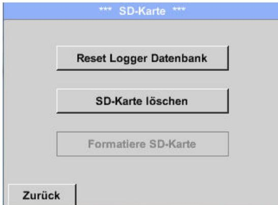
Mit Betätigen der Taste *Reset Logger Datenbank* werden die aktuell gespeicherten Daten für die Verwendung im DP500 gesperrt. Die Daten bleiben jedoch auf SD-Card gespeichert und sind für eine externe Verwendung verfügbar.
