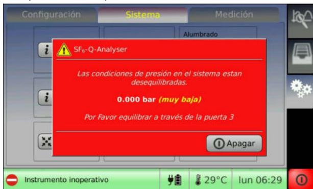
Para la compensación de presión, conectar una bolsa de recolección de gas con el gas deseado (bajo presión atmosférica, máx. 1.200 bar) en la salida para bolsa de recolección de gas ③.
