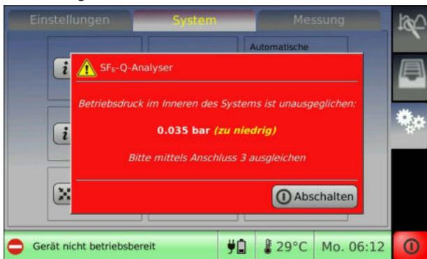
Für Druckausgleich einen Gasauffangbeutel mit gewünschtem Gas (unter atmosphärischen Druck, max. 1.200 mbar) an Ausgang für Gasauffangbeutel ③ anschließen.
