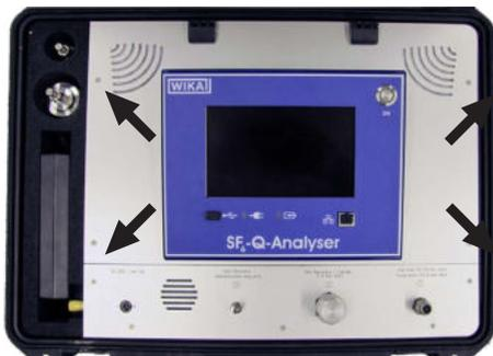
2. Retirer le connecteur du capteur (sur cet exemple : capteur SO<sub>2</sub>)
