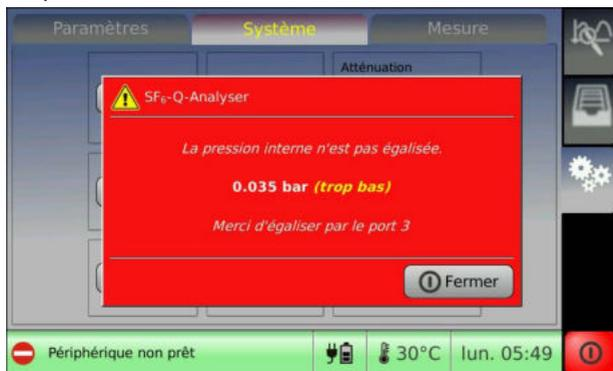
Pour la compensation de pression, connecter un sac de récupération de gaz avec le gaz voulu (sous pression atmosphérique, max. 1.200 mbar) à la sortie prévue pour un sac de récupération de gaz ③.
