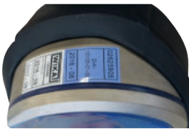
Fig. 2 - GDI-100-D con tapa protectora de goma
