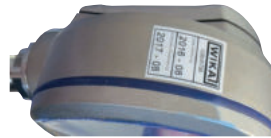
Fig. 3 - GDI-100-D sans capuchon de protection en caoutchouc
