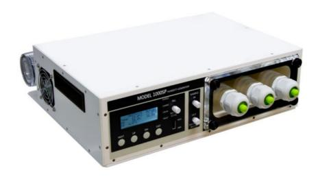
Kompakter, leichter Feuchte-Kalibrator mit schnell wechselbarem Trockenmittel und verbessertem Luftstrom
