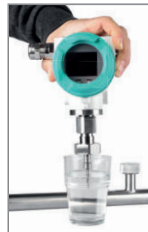
Der Sensor kann entfernt und gereinigt werden
