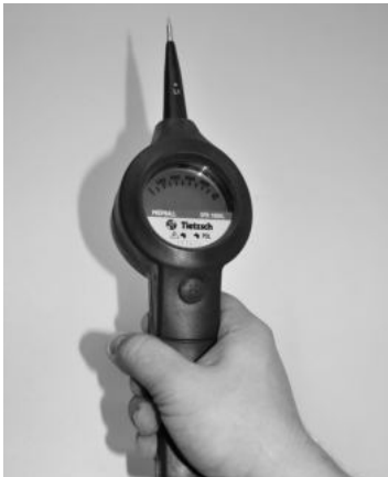
Gerät an der Handhabe des Anzeigeteils fest umfassen!
